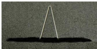
切った溝は接着剤を流し込み、補強および金具をしっかり固定します。0.6φのステン線3本を通し、強度試験を行った結果、タイル・金具には変化が見られず70kgでステン線が破断
